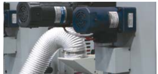
Motores independientes para ajustar tinteros
