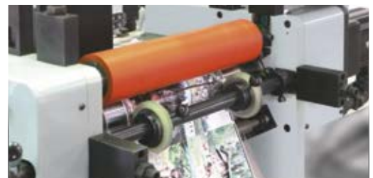
Sistema de tiro del material
